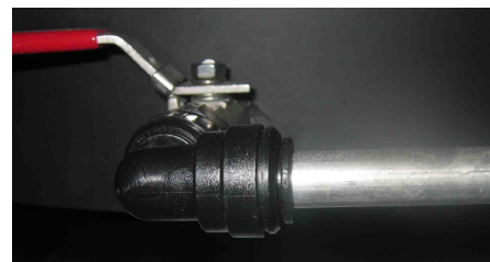
Fig 3: Modstrømskøleren monteres direkte på tappehanen.
