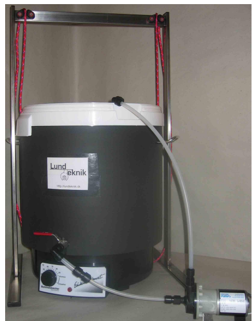
Fig 1: Recirkulering med pumpe.
