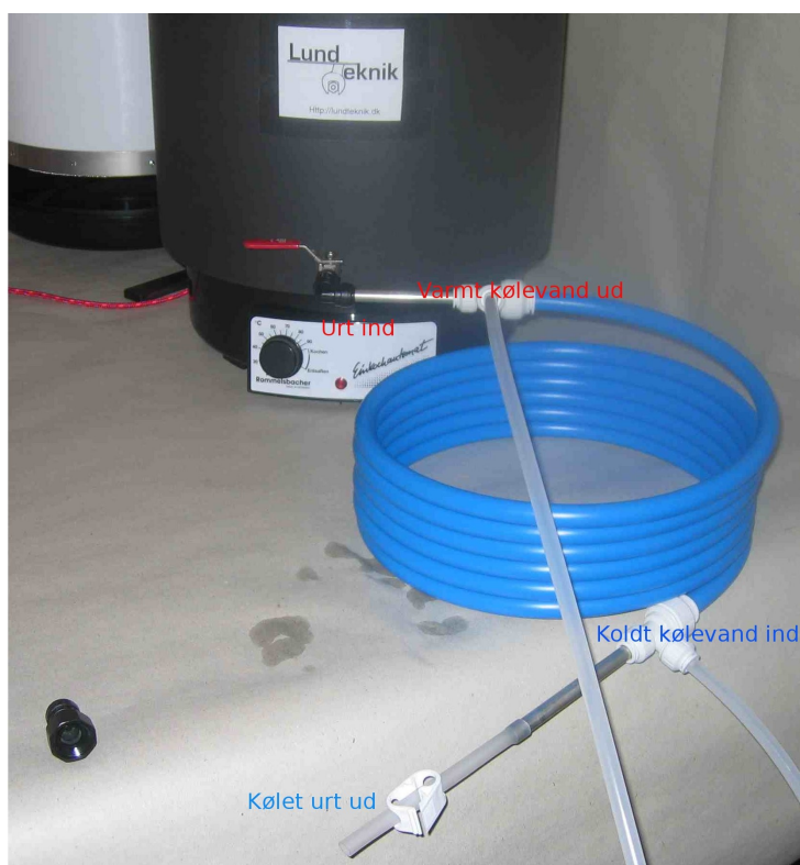
Fig 4: Forbindelser til modstrømskøler.
