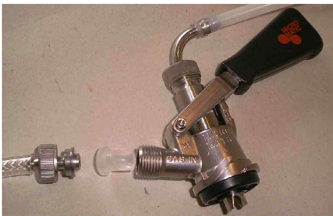
Fig. 5: Kombineret øl- og CO 2 kobling
