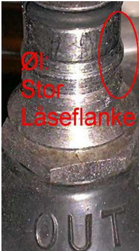
Fig. 8: Øl, Ud, stor låseflanke
